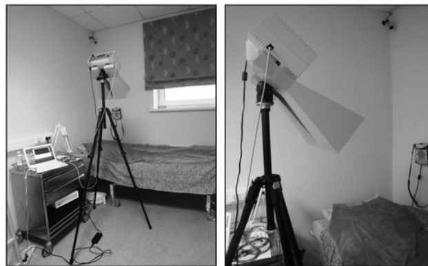
Рис. 1. Схема расположения БРЛ-системы при проведении эксперимента
