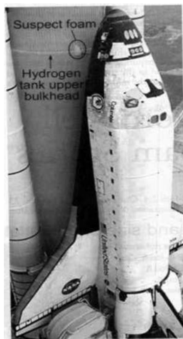
Рис. 3. Space Shuttle Columbia на стартовом столе (элементы конструкции желтого цвета – теплоизоляционное покрытие внешнего криогенного бака [6])
