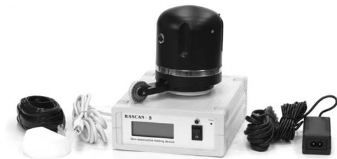
Рис. 8. Изображение подповерхностного радиолокатора «Раскан-5/15000» в комплекте поставки
