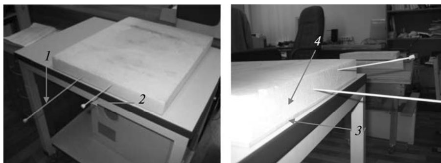
Рис. 13. Металлические спицы, воткнутые в пенополиуретановое покрытие образца:
