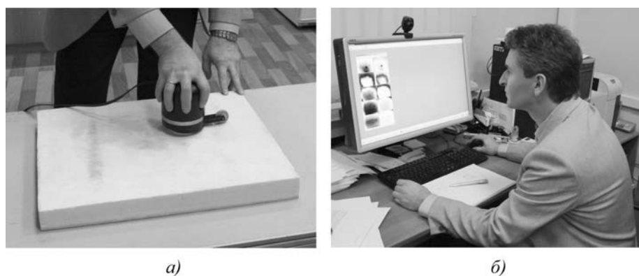
Рис. 10. Эксперименты с образцами теплозащитных покрытий: а – процесс сканирования образца; б – обработка результатов экспериментов
